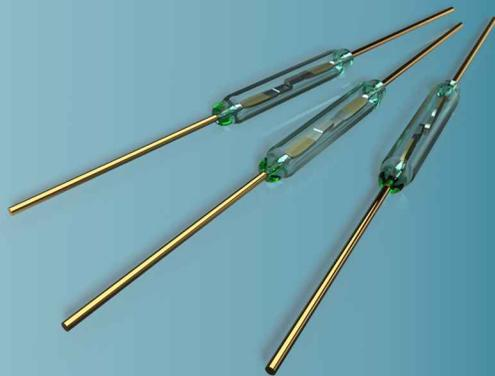
Для коммутации электрических цепей постоянного и переменного токов частотой до 10 кГц с активной нагрузкой
