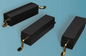
Для коммутации электрических цепей постоянного и переменного токов частотой до 10 кГц с активной нагрузкой
