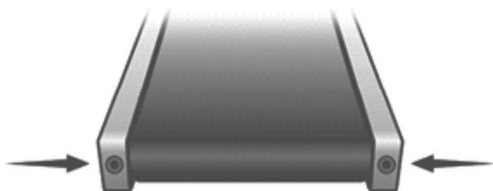
В случае появления проскальзывания необходимо на выключенной беговой дорожке повернуть оба регулировочных винта по часовой стрелке на  $\frac{1}{4}$  оборота. После этого необходимо провести проверку. Если проскальзывание осталось, то процедуру необходимо повторять до устранения проскальзывания. Если в процессе регулировки суммарно угол поворота составил один оборот и проскальзывание не устраниется - необходимо прекратить регулировку и обратиться в сервисный центр
