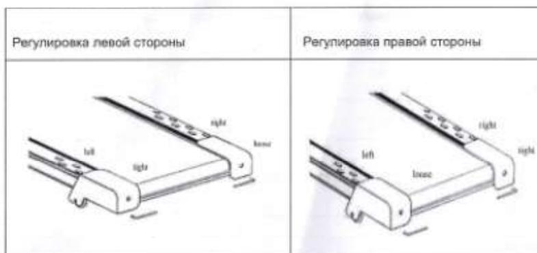
Отклонение бегового полотна серьезно повлияет на срок его службы. Пожалуйста, отрегулируйте полотно вовремя, когда заметите его смещение.
