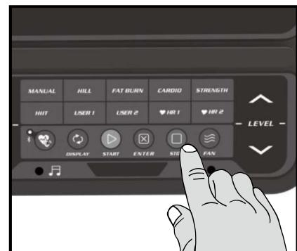
Нажатие и удержание клавиши **Stop** (Стоп) на протяжении 3 секунд приведет к полному **бросу** панели. Во время ввода данных в программу клавиша **Stop** (Стоп) выполняет функцию **возврата к предыдущему экрану**. Это позволит вам возвращаться на один шаг назад во время программирования.
