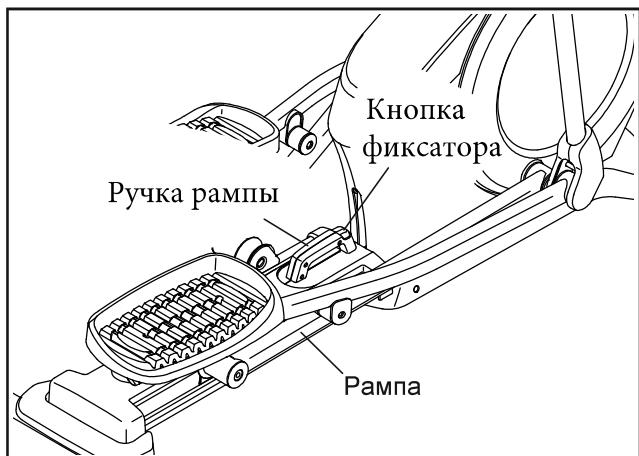
Чтобы опустить рампу, нажмите кнопку фиксатора, потяните за ручку и опустите рампу, установив нужный наклон. Затем опустите кнопку и вставьте фиксирующий стержень в одной из регулировочных отверстий на раме. Убедитесь, что стержень надежно вставлен в отверстие.
