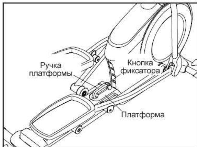
Чтобы опустить платформу, нажмите кнопку фиксатора, потяните за ручку и опустите платформу, установив нужный наклон. Затем отпустите кнопку и вставьте фиксирующий стержень в одно из регулировочных отверстий на раме. **Убедитесь, что стержень надёжно вставлен в отверстие.**
