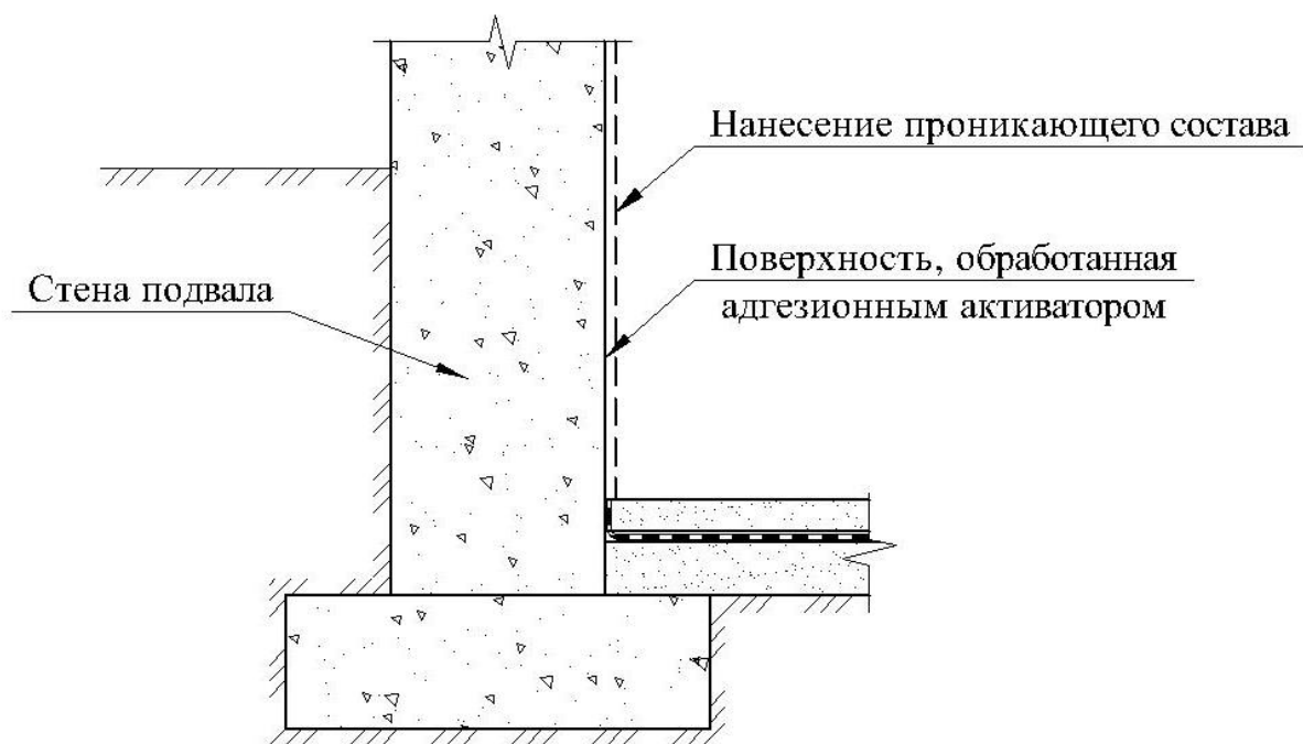
Рисунок 4. Устройство проникающей гидроизоляции
