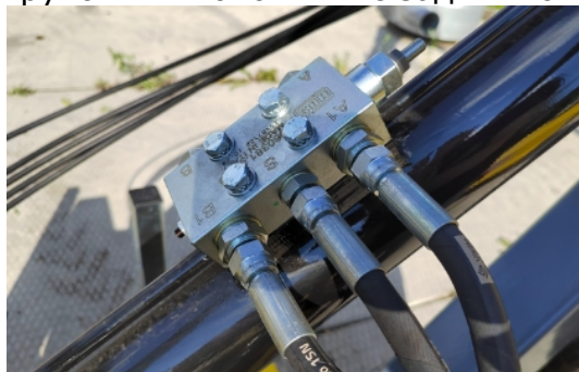
Гидроцилиндр стрелы с гидрозамком; рукояти и головки – с задвижкой
