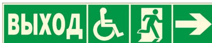
Рисунок 5 Пример комбинации эвакуационных знаков
