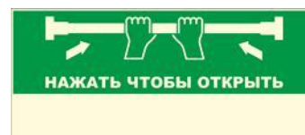
б) знак для дверей «Антипаника» с экраном
