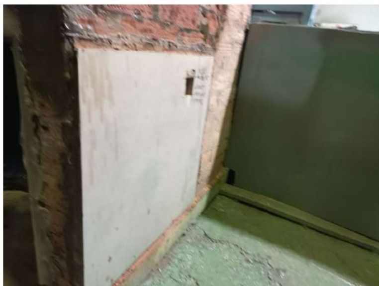
Рис.22,23 Испытательный стенд для по проверки адгезионных свойств на различных типах материалов и различных составах материала «ДеКом»
