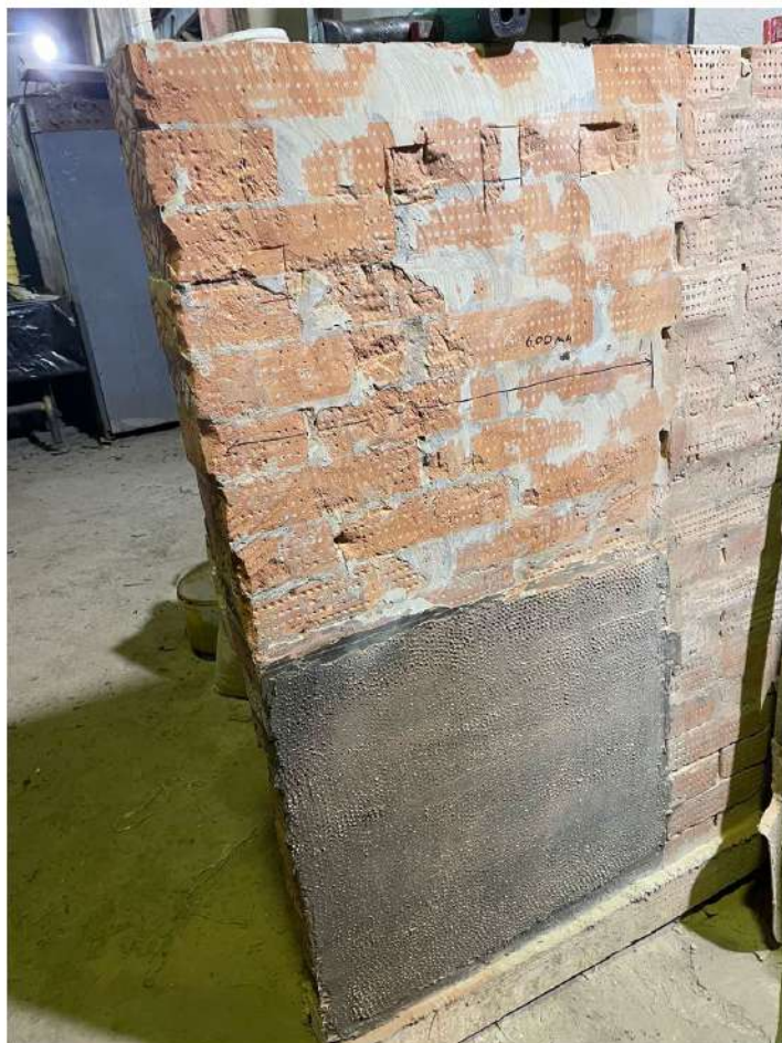
Рис.20,21 Испытательный стенд для по проверки адгезионных свойств на различных типах материалов и различных составах материала «ДеКом»
