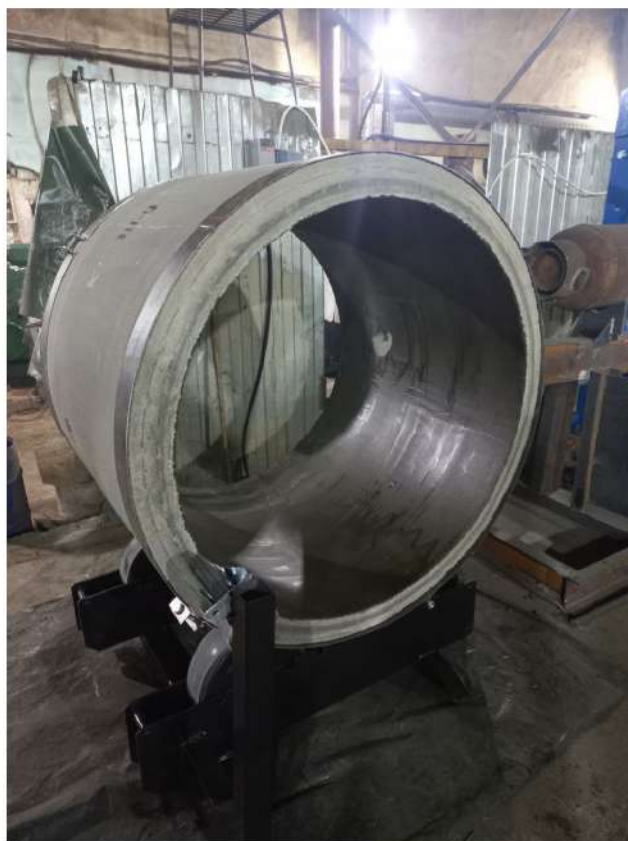
Рис.25 Механизированная экспериментальная установка для нанесения состава «ДеКом» на ж/б кольца
