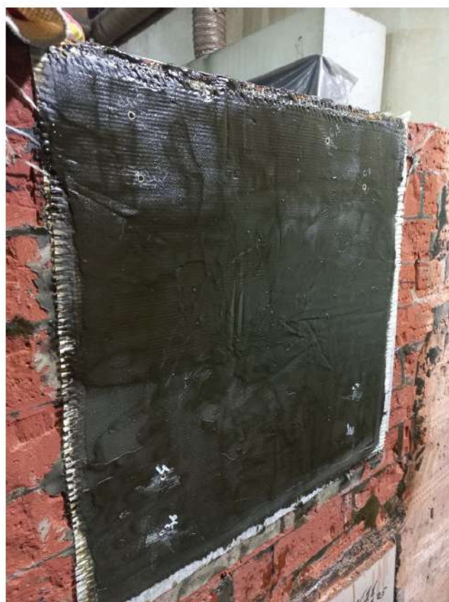
Рис.22,23 Испытательный стенд для по проверки адгезионных свойств на различных типах материалов и различных составах материала «ДеКом»
