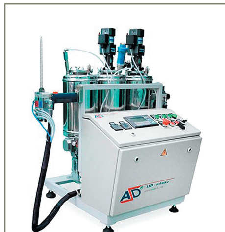
Рис. 12. Пример установки для смешивания и дозированной подачи особо вязких компаундов для герметизации соединителей
