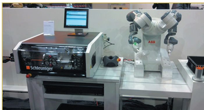
Рис. 9. Работа линии мерной резки и зачистки производства компании Schleuniger AG с коботом на основе двух манипуляторов
