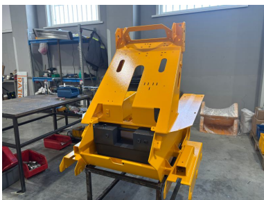
Порошковая окраска с защитой от коррозии
