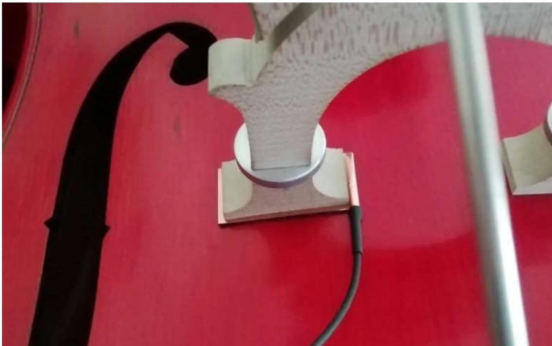
Если ножки вашей подставки не повторяют изгиб верхней деки, их следует аккуратно подточить. Нижняя поверхность ножки должна точно соответствовать дуге деки – это важно для равномерного давления, правильной передачи вибраций и, как следствие, – качественного звучания звукоснимателя.
