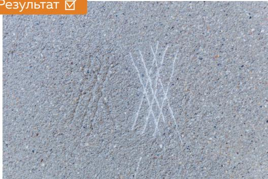
На фотографии **сравнение поверхностной прочности основания ДО (слева) и ПОСЛЕ (справа)** применения грунт-праймера. Аналогичный результат должен получиться у Вас при условии правильного применения продукта. Поверхностную прочность основания оценивали с помощью Ri-Ri теста.
