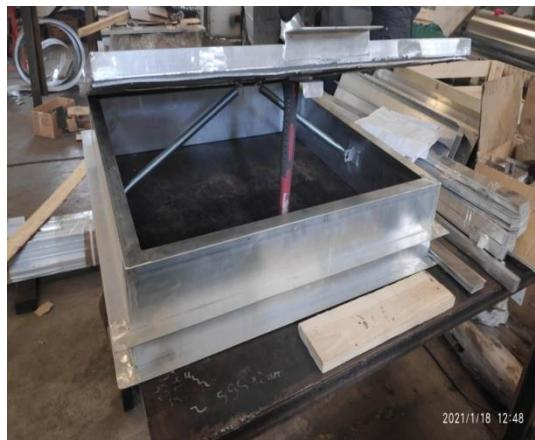
Люк-лаз клапан (люк перехода) предназначен для обеспечения перехода обслуживающего персонала в пространство под понтоном, а также для предотвращения образования вакуума под понтоном.
