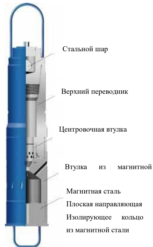
Магнитный ловитель с обратной циркуляцией
