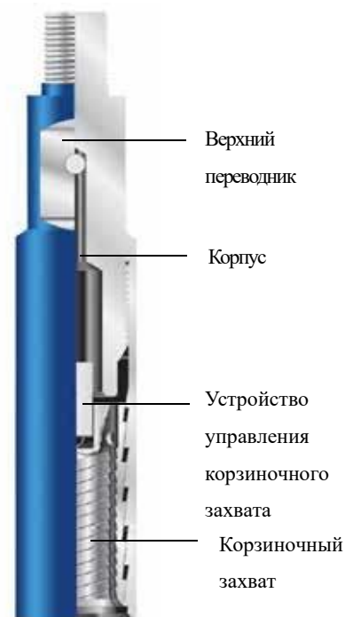
Ловитель насосных штанг с коротким захватом серии 20
