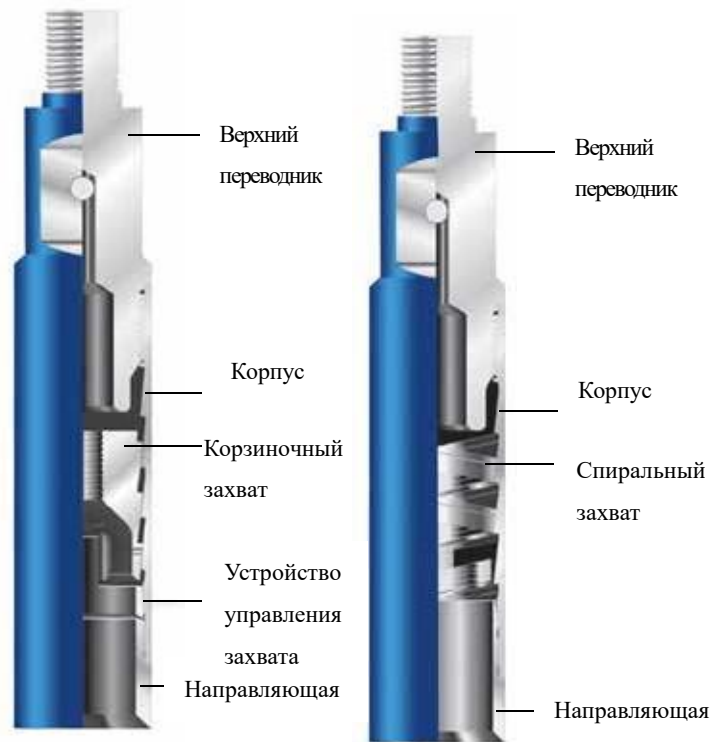
Ловитель насосных штанг серии 10 с корзиночным захватом
