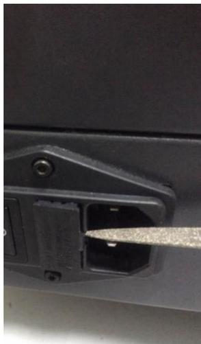
*Рисунок 14. Открытие крышечки предохранителя*
