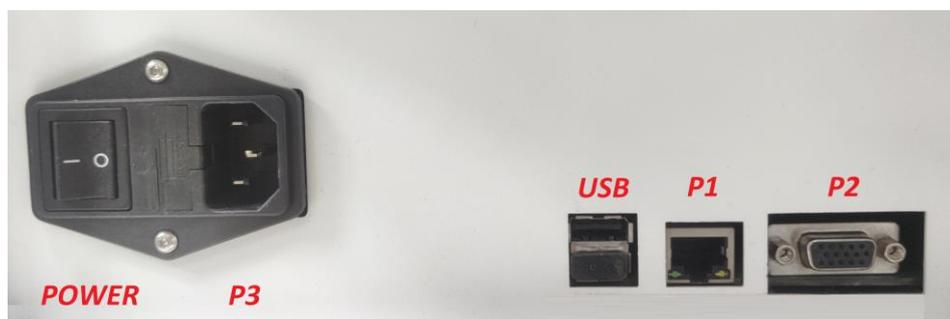
Рисунок 2. Интерфейс источника питания и связи KF-PRO-040-НІ
