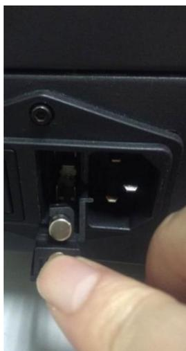
*Рисунок 15. Извлечение предохранителя*
