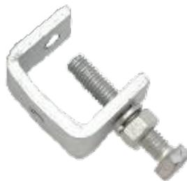
Состоит из 1 U-образного кронштейна, 1 болта, 1 гроверной шайбы, 1 гайки. Покрытие Dacromet обеспечивает высокую устойчивость к коррозии и позволяет использовать продукт в условиях высокой влажности и агрессивной среды.
