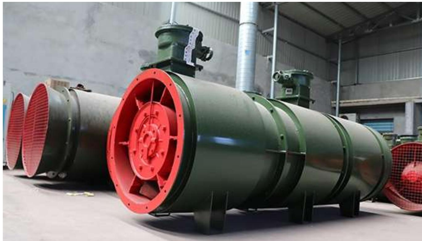
Вентиляторы для горных выработок и туннелей серий GAL3-15/15 - GAL14-1100/1100 имеют герметичный двигатель, пылезащиту, рабочее колесо устойчивое к агрессивным средам, виброгасители, защита от ударов, совместимость с ЧРП. Могут комплектоваться шумоглушителями, протяженными гибкими воздуховодами, а также диспетчерскими пультами.
