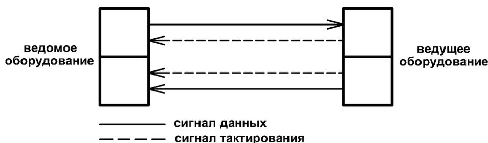
Рис. 3 – Противонаправленный интерфейс
