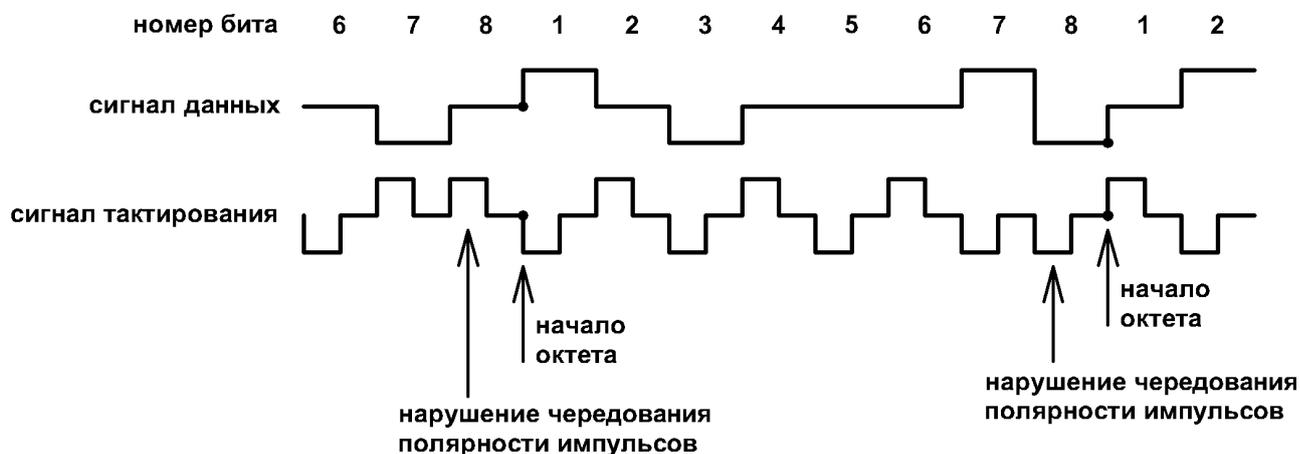
Рис. 6 – Сигнал данных на выходе передатчика и комбинированный сигнал тактирования
