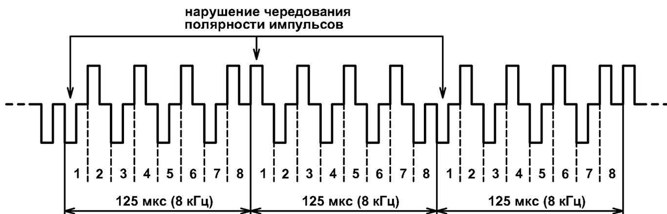
Рис. 33 – Структура сигнала для режима а)
