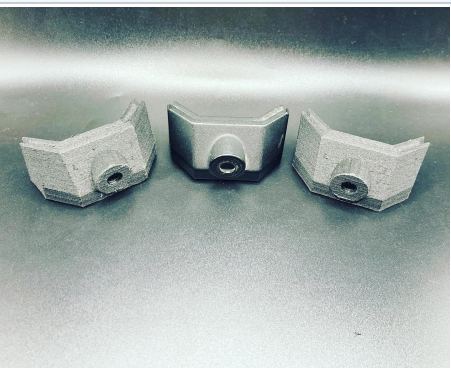
Заглушки натяжителя для японского мотоцикла Kawasaki Z800 из PA12 GF
