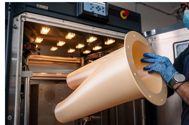
Y-образный патрубок для авиакосмической техники, напечатанный из ULTEM 9085
