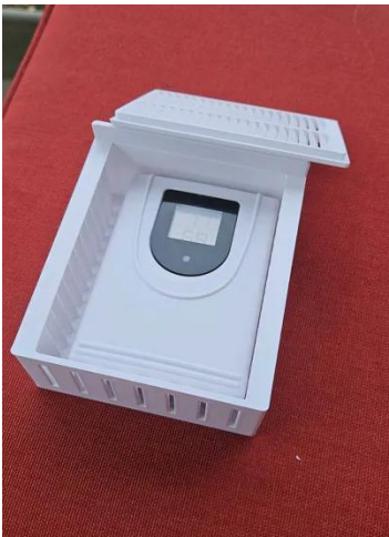
Герметичный защитный корпус из PETG для внешних датчиков мониторинга
