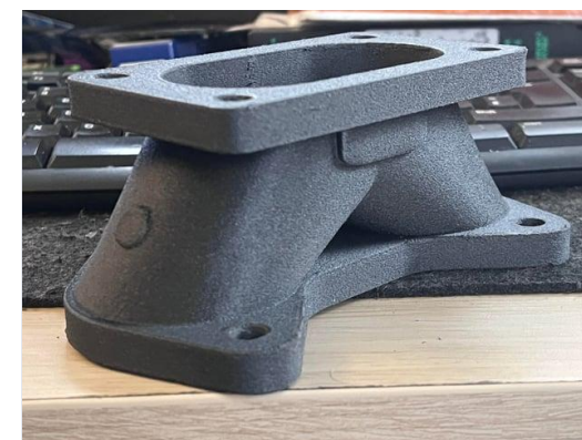
Адаптер для Porsche 924 для замены системы K-Jet на карбюратор из PA6 GF
