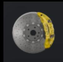
10-поршневая углеродно-керамическая композитная тормозная система Lotus
