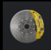
10-поршневая углеродно-керамическая композитная тормозная система Lotus
