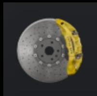
10-поршневая углеродно-керамическая композитная тормозная система Lotus
