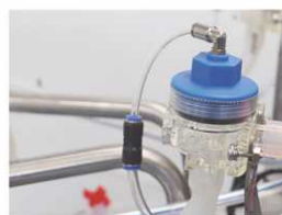
Автоматическое снятие чашки для предотвращения чрезмерного доения
