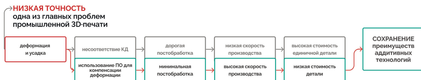
Рис. 1. Влияние ПО для предеформации на эффективность аддитивного производства.
