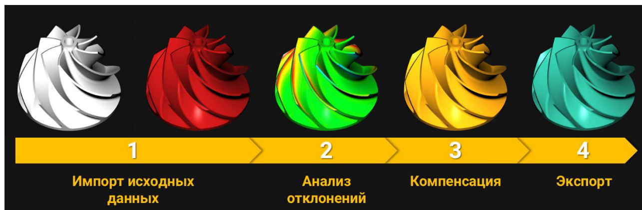
Рисунок 2.1.1 Этапы компенсации технологических деформаций в ПО Reditive Compensation©
