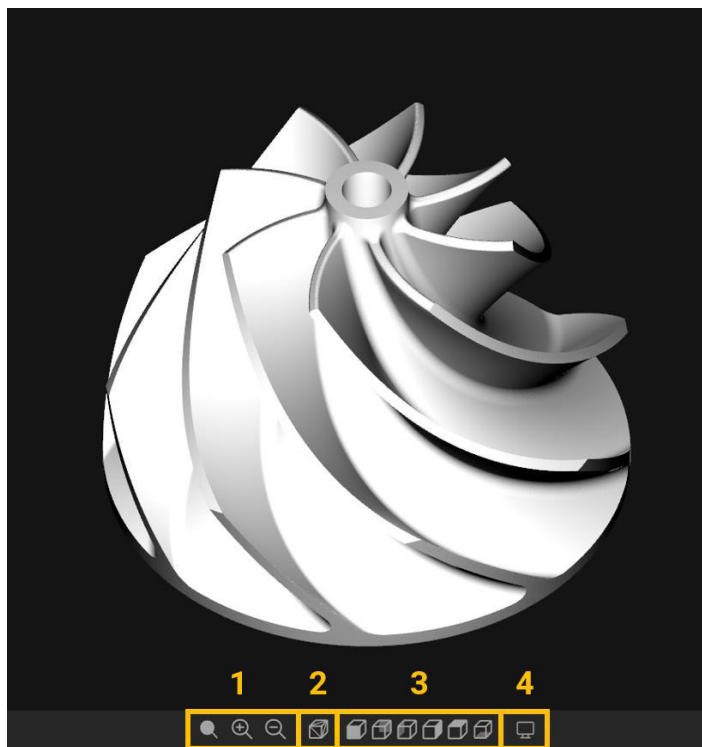
Рис. 4.1.3 Графическое окно и инструменты управления видом 3D-модели
