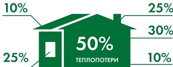
Теплопотери через ограждающие конструкции достигают 50%. Средний расход на отопление в год = 229 кВт • ч/м<sup>2</sup>.
