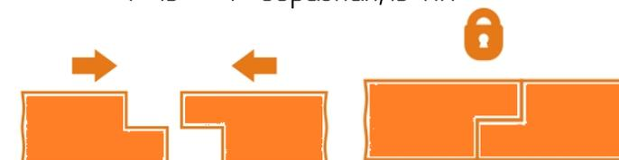
Г-образная кромка обеспечивает 100% однородность слоя теплоизоляции
