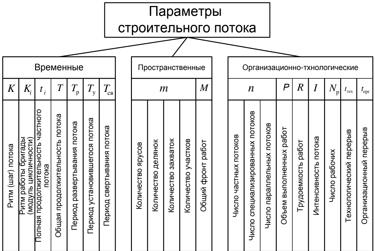
Рисунок 3.3 Классификация и обозначение параметров строительных потоков
