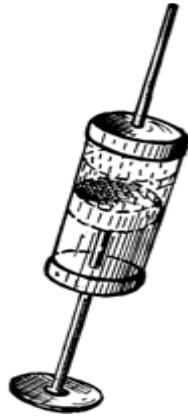
Рис. 2. – Шприц для определения концентрации CO 2
