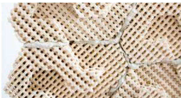
Рисунок 1. Новый стройматериал - кирпич с охлаждением
