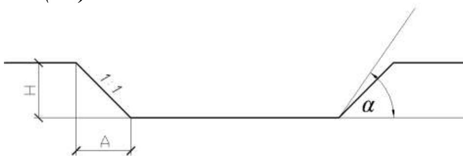
Рисунок 4. Определение крутизны откоса
