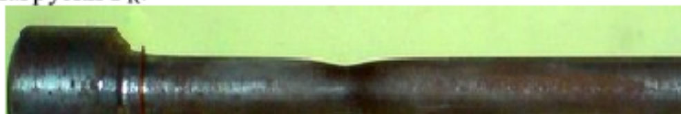
Стальной образец с "шейкой"
