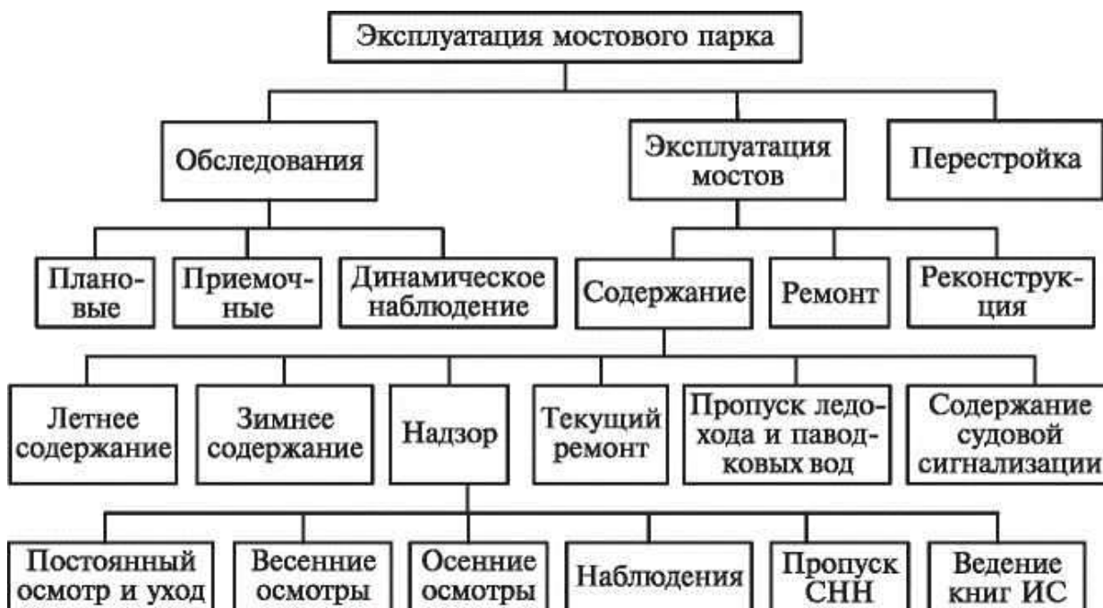
Рис. 1. Структура работ по эксплуатации мостового парка
