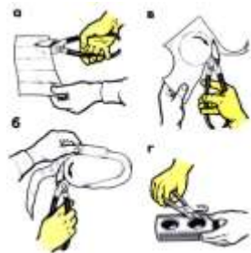
Рис. 17. Резание ножницами жести толщиной до 0,5 мм: а - положение пальцев на рукоятке при резании ножницами, б - правыми, в - левыми, г - вырезание внутреннего криволинейного контура
