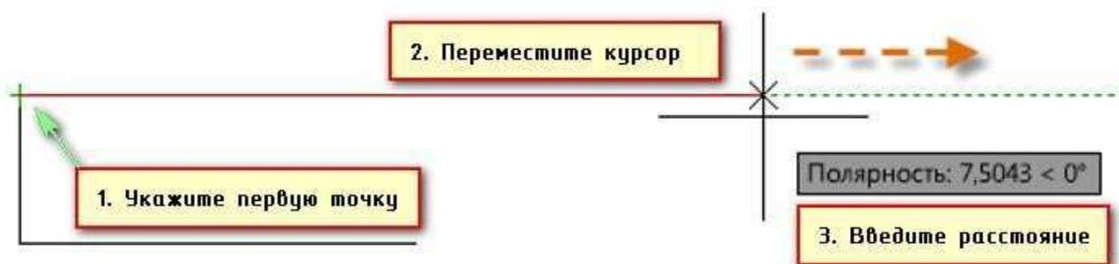
По умолчанию полярное отслеживание активируется и направляет курсор по вертикальной или горизонтальной оси (от 0 до 90 градусов). **Фиксирование углов**
