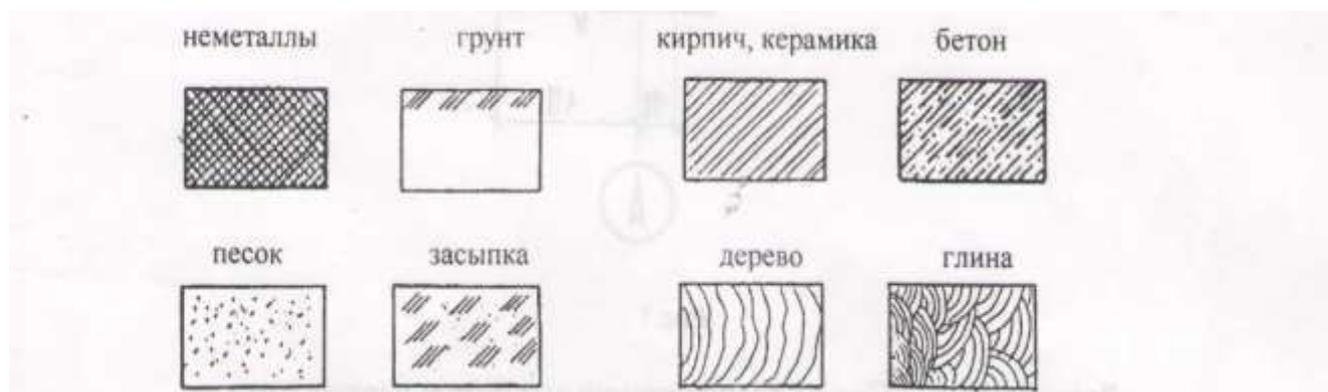
При изображении строительных материалов в сечение условные обозначения должны соответствовать ГОСТ 2.306-68 и выполняться линиями по ГОСТ 2.303-68\*. Угол наклона линий - 45°, слева на право, толщина линий S/2, контуры фигуры сечения обводить сплошной толстой линией. Без применения чертёжных инструментов вычерчиваются изображения песка, глины, дерева, засыпки.
