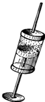
Рис. 2. – Шприц для определения концентрации CO 2
