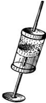
Рис. 2. – Шприц для определения концентрации CO 2
