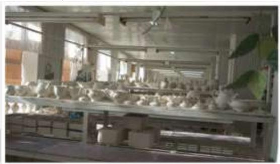
Здесь фарфоровую массу (шликер) заливают в гипсовые формы. Литейщица, вынув влажное изделие из формы, делает резной узор от руки.
