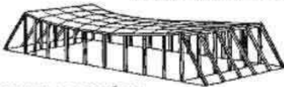
покрытие с железобетонными оттяжками /гаран в Новосибирске/
