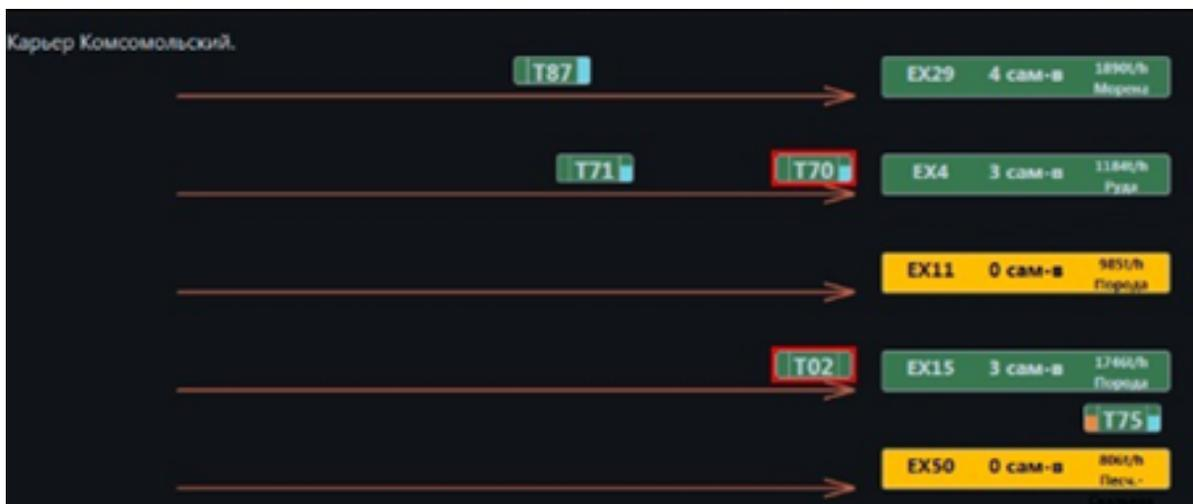
В правой части экрана отображаются загруженные самосвалы на пути к местам разгрузки или уже прибывшие на разгрузку.
