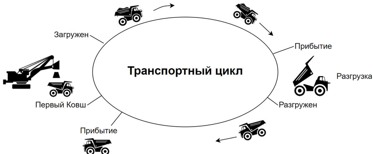
Пример расчета ТРОН карьерного самосвала - Перевезено Тонны 205 т; Время пустого пути = 600 сек; Время ожидания = 150 секунд; Время пятна = 65 секунд; Время загрузки = 150 секунд; Время полной перевозки = 900 секунд; Время разгрузки = 60 сек. ТРОН =  $205 / (600 + 150 + 65 + 150 + 900) / 3600 = 402 \text{ т / ч}$ .
