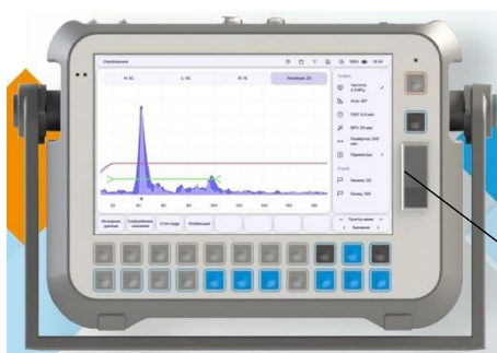
Рис. 1. Общий вид дефектоскопа АВИКОН-20
