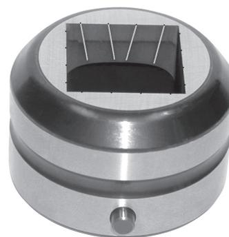
Вырезы Mate Slug Free Light™ нарезаются под углом для создания ряда выступов на вырубной части. Поскольку вырубленная пластина продвигается через матрицу, выступы упираются в оформляющий канал матрицы, что предотвращает выход отхода обратно на поверхность листа. (Изображение увеличено для дополнительной четкости)
