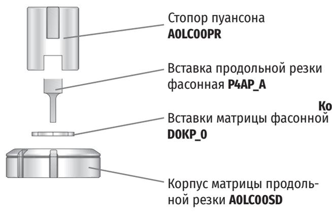
**Компоненты инструмента продольной резки**
