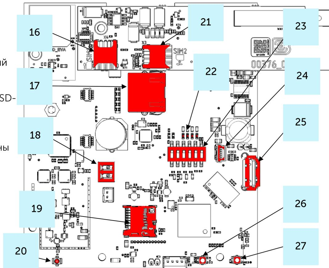
Базовая станция подключается к сети интернет 8-жильным сетевым кабелем (витая пара), через разъем 8P8C на плате. Кабель может быть обжат по стандартам T568A и T568B. Контакты нумеруются с 1-го по 8-й справа налево.
