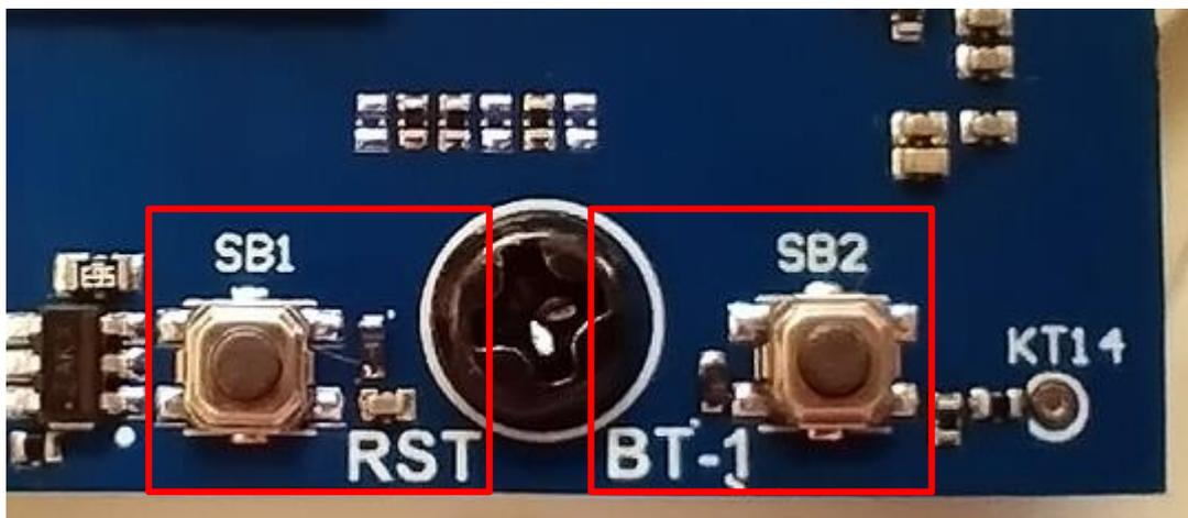
Кроме того, на плате расположены **сервисные переключатели**, которые предназначены для выбора способа загрузки образа прошивки: с внутренней памяти, с SD-карты или через USB-хост с компьютера и используются только в условиях сервиса. В рабочем режиме переключатели должны быть отключены.
