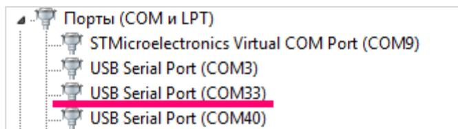
После этого открыть программу PuTTY, выбрать способ подключения **Serial**, и ввести номер виртуального COM-порта базовой станции и скорость (115200) в соответствующие поля.
