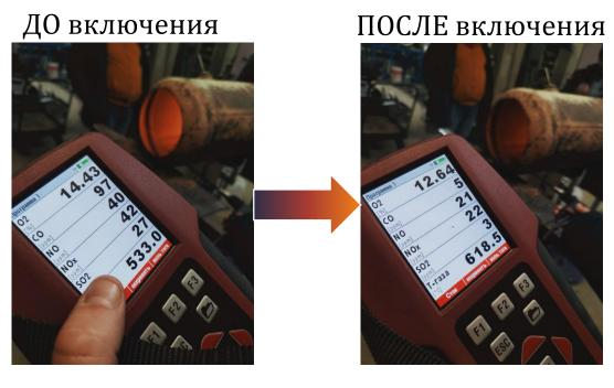
водород частично замещает углеводородное топливо и улучшает процесс горения; ГИДРОКСИЛЬНАЯ ГРУППА, более являясь реакционноспособным окислителем, чем кислород - обеспечивает полное сгорание природного газа соответствующим снижением токсичных выбросов в атмосферу и увеличением энергоэффективности генерирующего агрегата.
