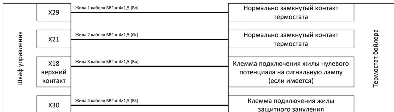
Подключение насоса отопления первого этажа
