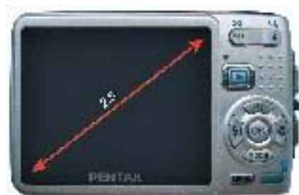
Размер ЖК монитора определяется в дюймах по диагонали кадра
