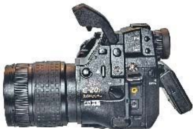
Полупрофессиональный фотоаппарат с поворотным ЖК монитором
