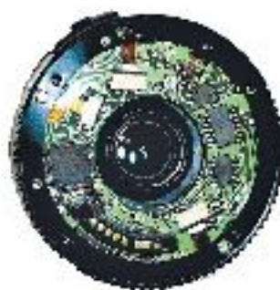
Мини-компьютер, встроенный в объектив
