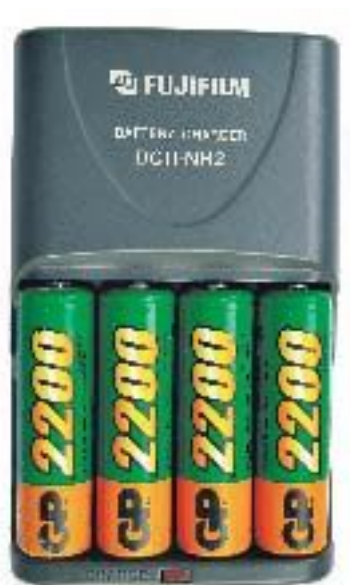
Зарядное устройство для аккумуляторов типа AA
