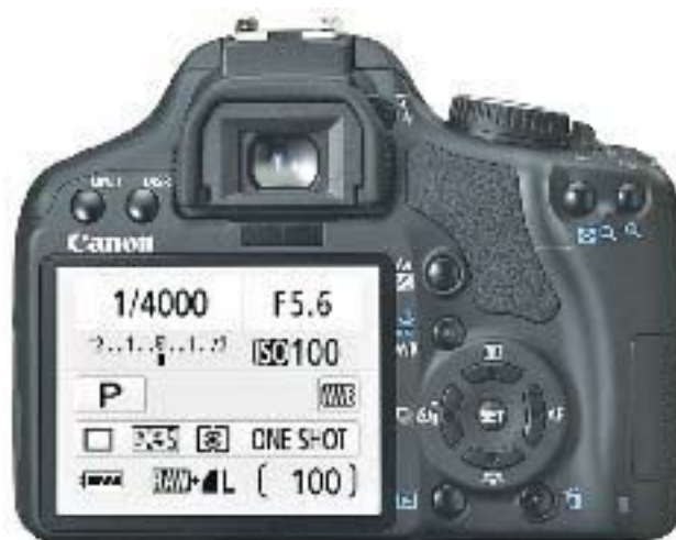
Полупрофессиональный фотоаппарат без дисплеев. Настройки, контроль и управление осуществляются через ЖК монитор (размер 2,5 дюйма)
