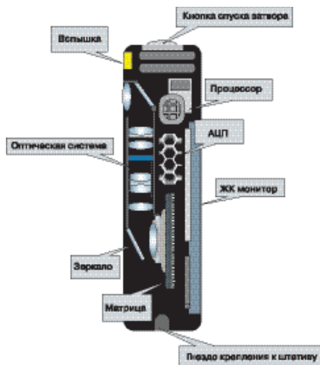
Устройство компактного аппарата с внутренней оптической системой
