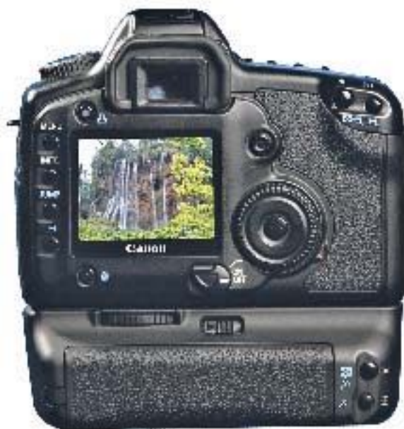
ЖК монитор полупрофессионального фотоаппарата (размер 2,5 дюйма)
