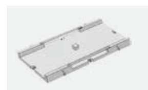
Разветвительный большой лоток на четыре направления. Над проемами в боковых стенках установлены опорные полосы. На дно лотка установлен опорный кубик для поддержки крышек типа КЭУ, устанавливаемых на опорные полосы.
