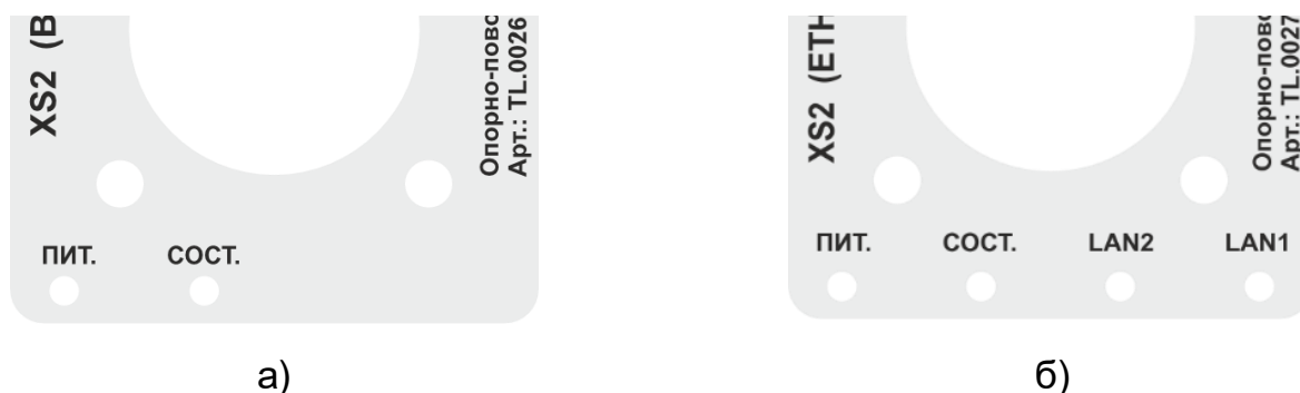
Рисунок 2 – Индикаторные светодиоды: а) TL.0026; б) TL.0027
