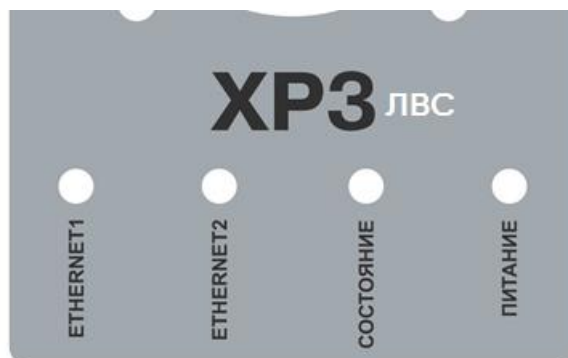
Рисунок 2 – Индикаторные светодиоды: а) TL.0026; б) TL.0027
