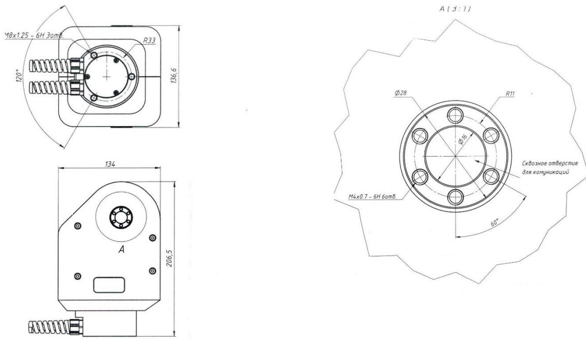
Рисунок А2 – Присоединительные размеры опорно-поворотного устройства
