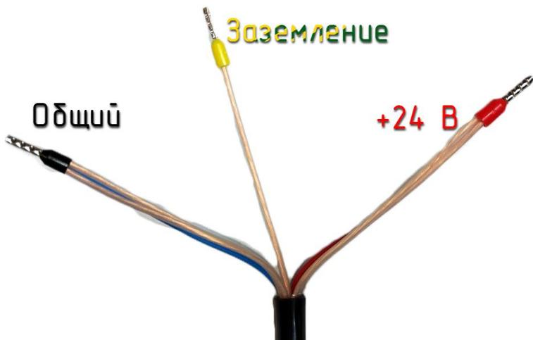
Рисунок 2 – Внешний вид кабеля питания ОПУ
