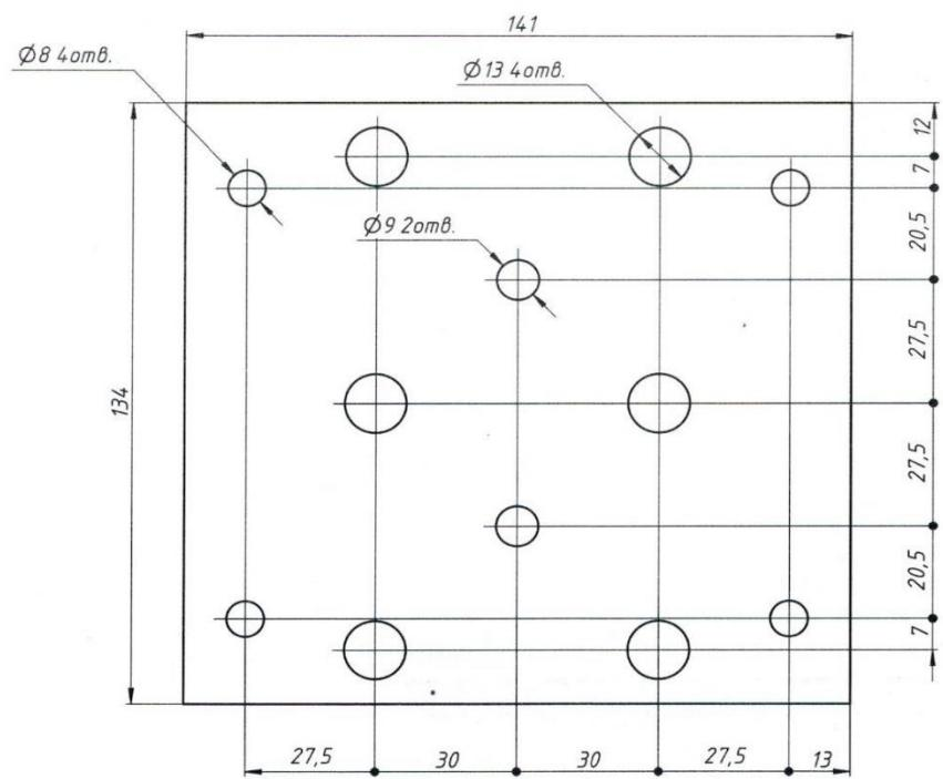
Рисунок А3 – Присоединительные размеры кронштейна полезной нагрузки
